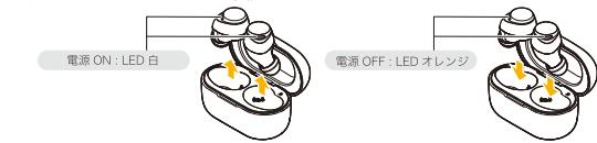
チャージングケースに収納する際は、イヤホン本体の LED がオレンジに点灯していることを確認してからケースを閉じてください。
