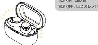
イヤホン本体を出し入れすることで電源ON/OFFが切り替わります。充電ケースに収納する際は、オレンジのランプが点灯していることを確認してからケースを閉じてください。
