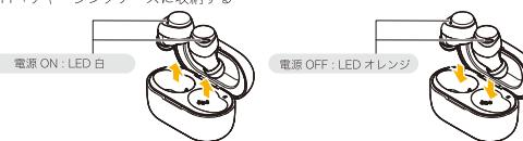
チャージングケースに収納する際は、イヤホン本体の LED がオレンジに点灯していることを確認してからケースを閉じてください。
